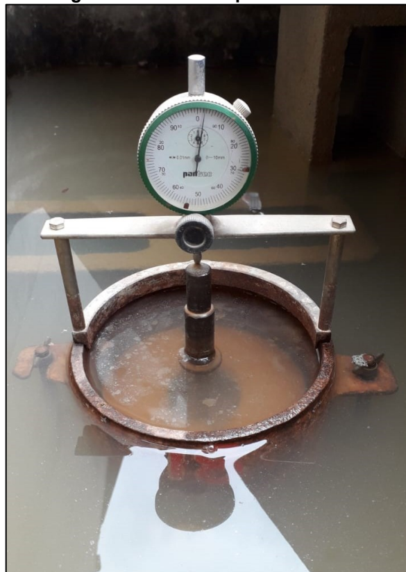
Figura 6 - CP no tanque de imersão
