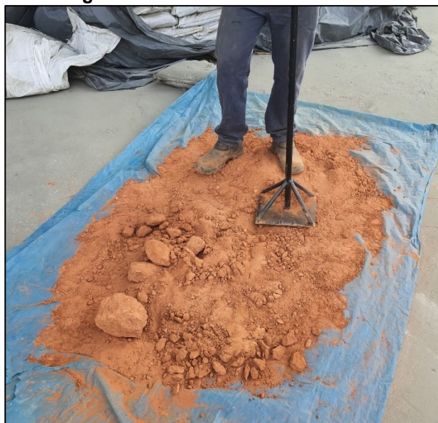
Figura 13 - Destorroamento do solo
