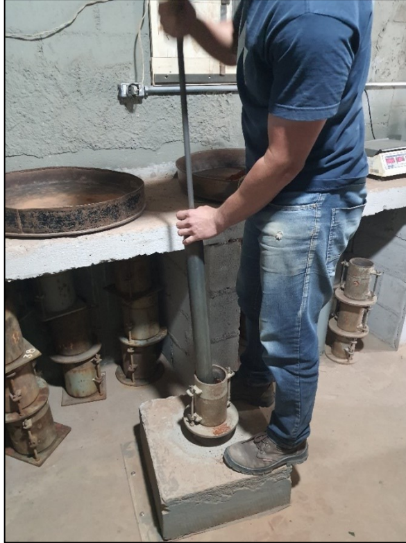
Figura 5 - Aplicação de golpes no ensaio de compactação
