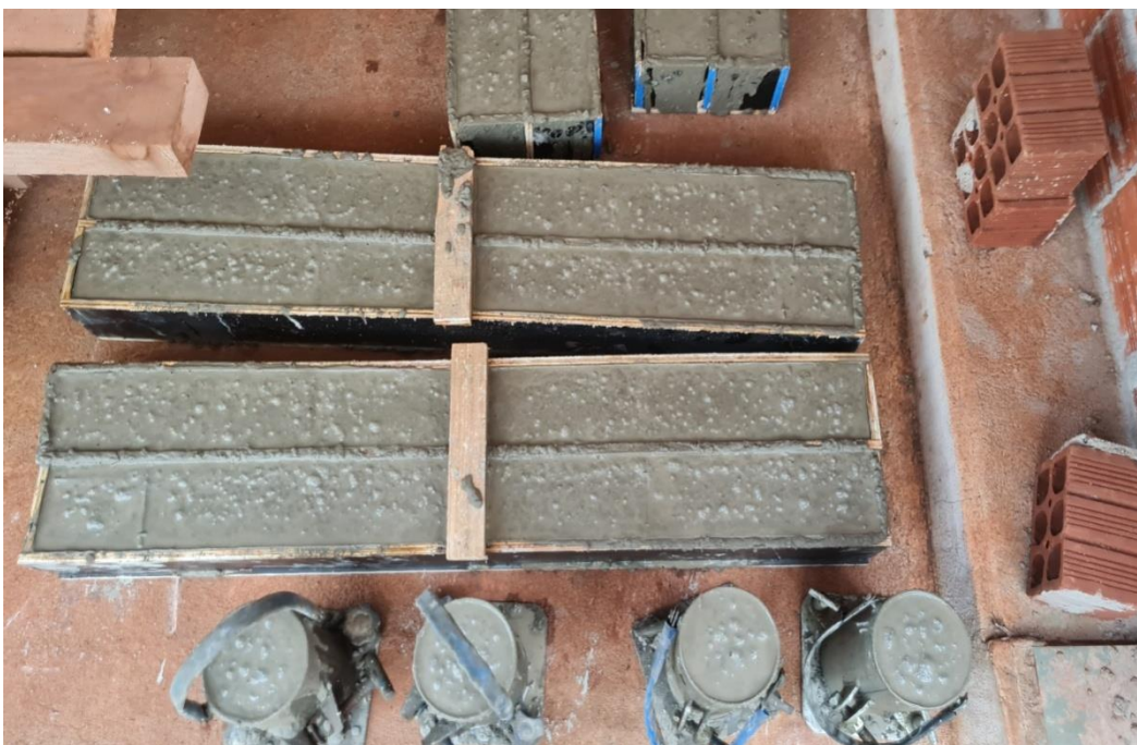
Figura 27: Vigas e corpos de prova concretados.
