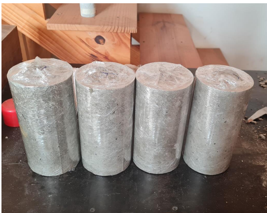
Figura 29: Corpos de prova pronto para serem ensaiados.
