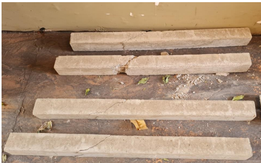
Figura 33: Vigas rompidas (adesivo estrutural).
