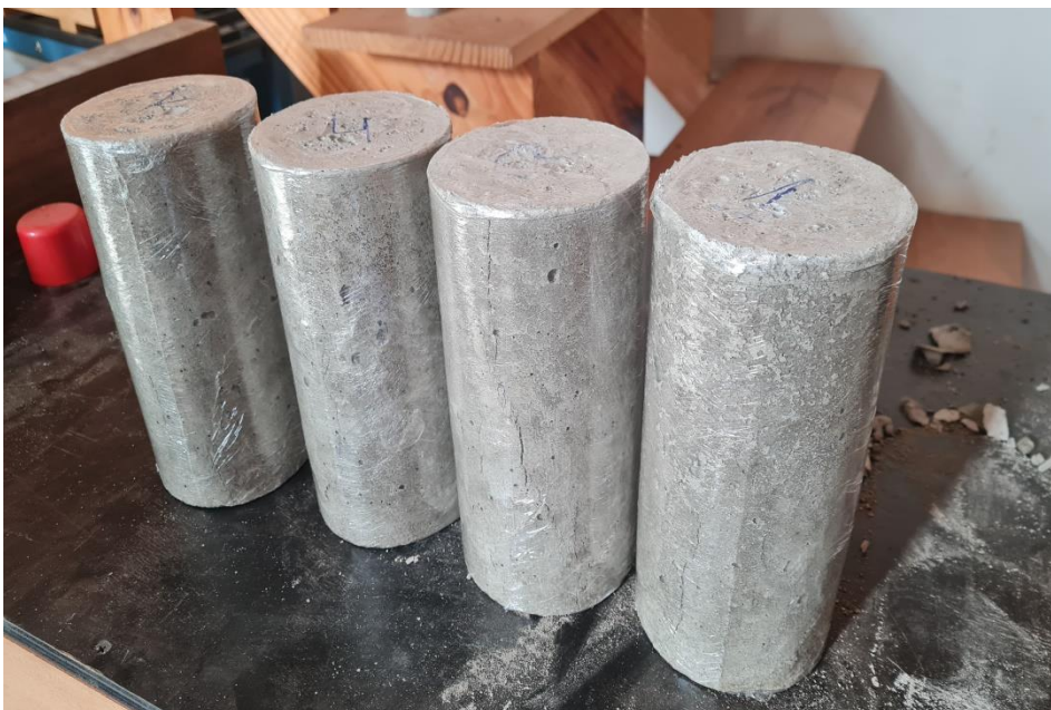
Figura 32: Corpos de prova rompidos.
