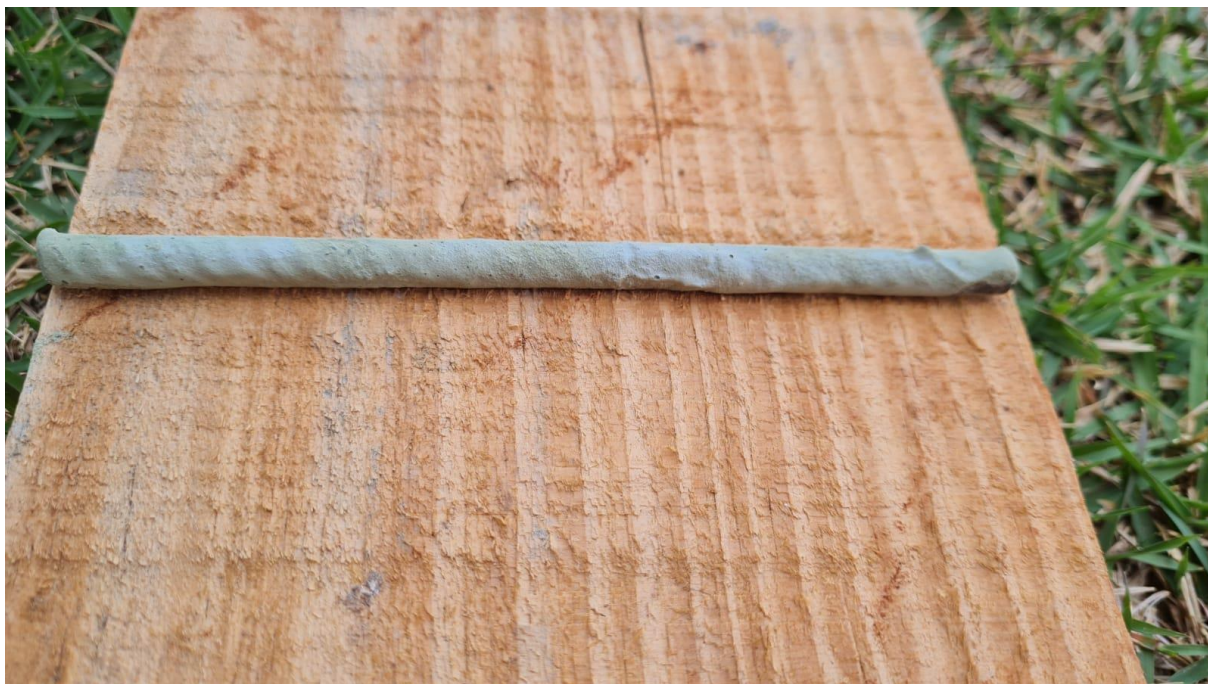
Figura 21: Armadura tratada com o protetor de armadura Quartzolit.
