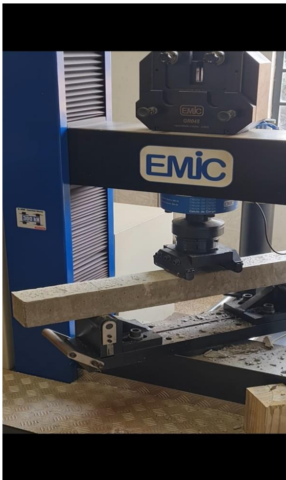
Figura 31: Viga sendo ensaiada.
