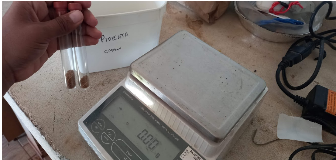
Imagem 3. Capsaicinóides sendo pesada em balança semi-analítica
