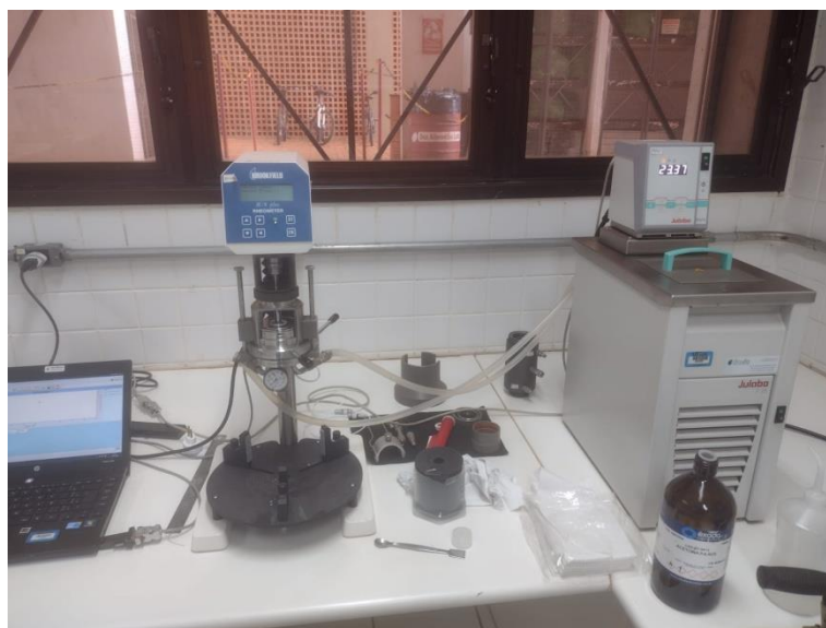
Figura 11 - Viscosímetro ICI (Cone e Placa) - Rêmetro rotacional
