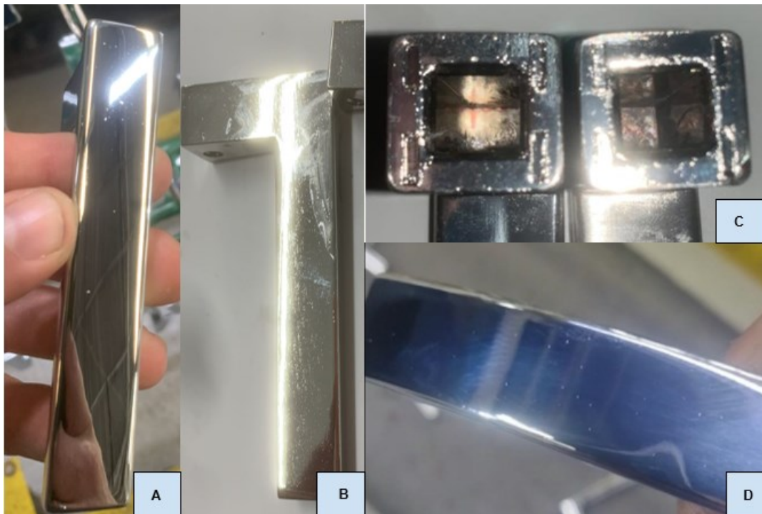
Figura 11 - Principais defeitos encontrados na etapa de Galvanoplastia A- asperezas, B- manchas, C- mal fechamento, D- chuviscos.
