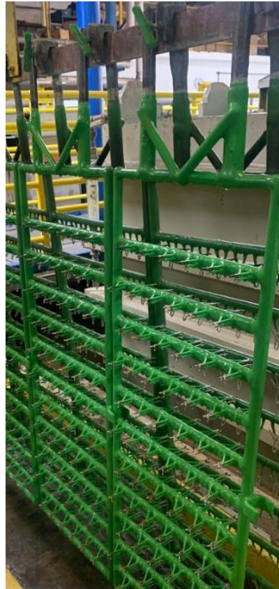
Figura 4: Gancheira de linha automática de galvanoplastia.
