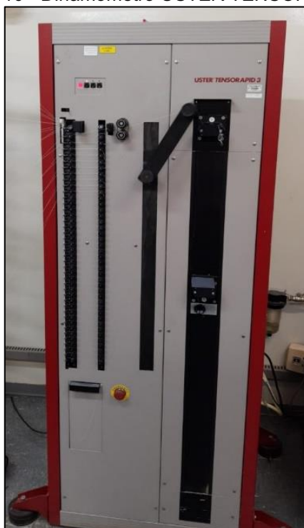
Figura 10 - Dinamômetro USTER TENSORAPID 3
