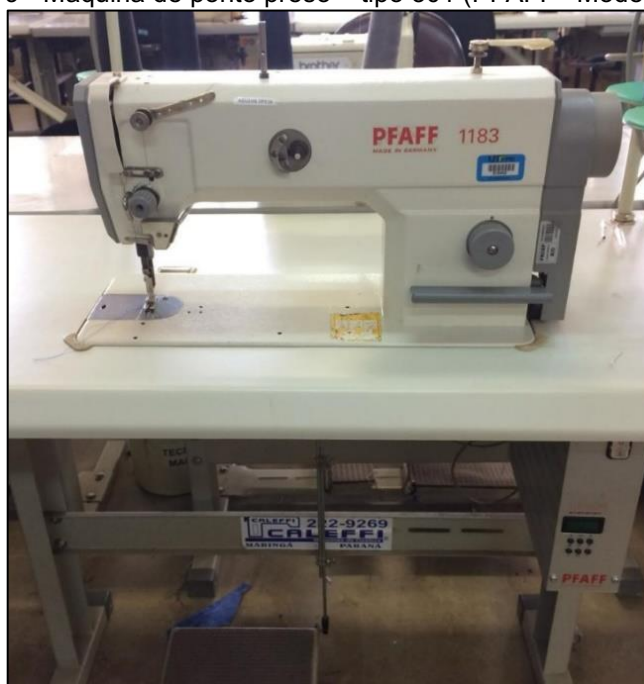
Figura 9 - Máquina de ponto preso – tipo 301 (PFAFF® Modelo 1183)
