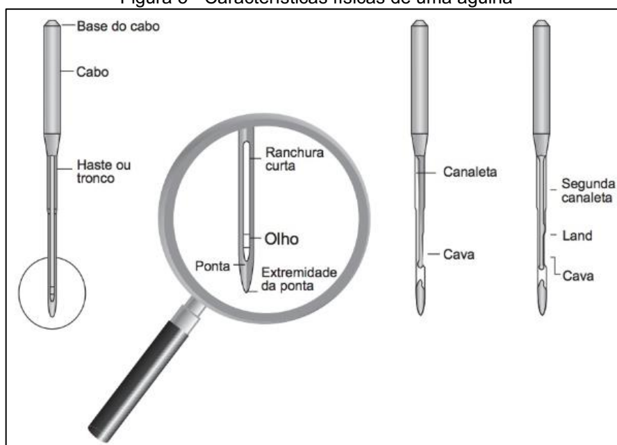
Figura 5 - Características físicas de uma agulha
