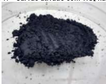
Figura 17 - Carvão ativado com \text{TiO}_2 na mufla
