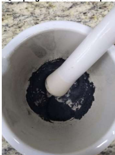
Figura 6 - TiO 2 impregnado ao carvão por maceração
