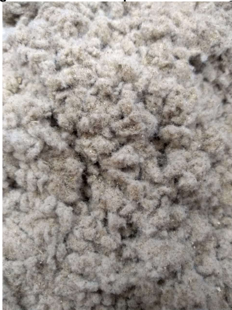
Figura 2 - Resíduo de pó de filtro da fiação
