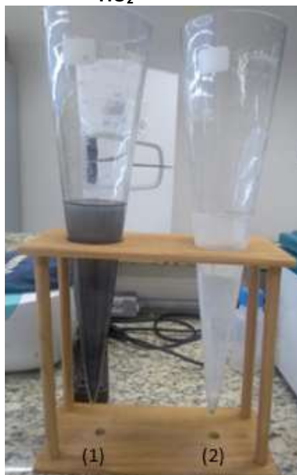
Figura 24 – (1) Decantação do carvão ativado incorporado \text{TiO}_2 (2) Decantação do \text{TiO}_2
