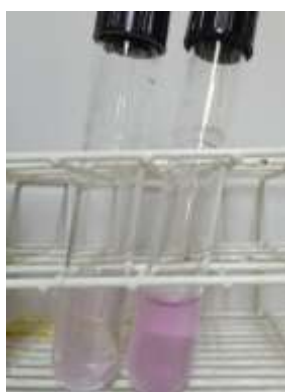
Figura 29 - Comparação de turbidez de solução imediatamente após a inoculação (à esquerda) e turbidez de solução após 4h em estufa a 35°C (à direita) Fonte: Autoria própria, 2022.
