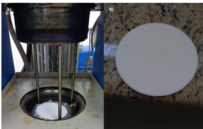
Figura 17 – Etapas do processo de prensagem isostática: A) Inserção do corpo de prova na cavidade da prensa; B) Corpo de prova após a prensagem.
