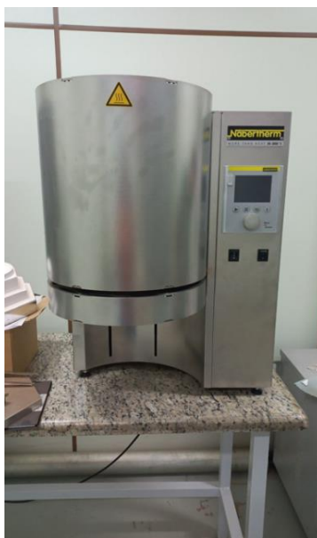
Figura 18 – Forno utilizado na pré-sinterização e na sinterização.
