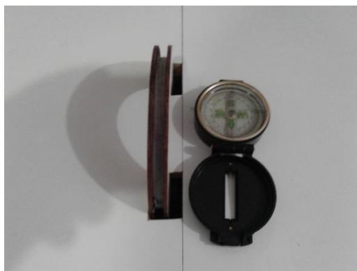
Figura 9 – Bobina e bússola posicionada em paralelo
