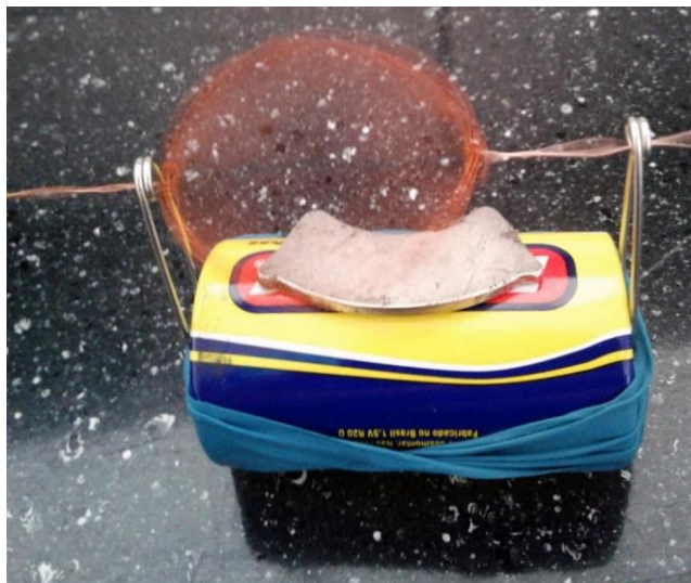
Figura 16 – Imagem do motor didático em funcionamento
