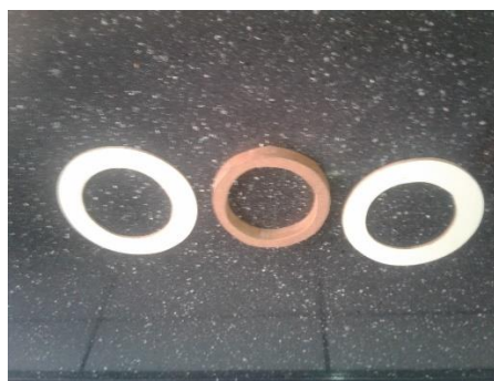
Figura 5 – Materiais para construção da bobina
