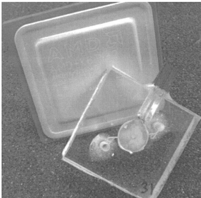
Figura 3 – Microbomba de deslocamento recíproco com válvulas tesla em acrílico.
