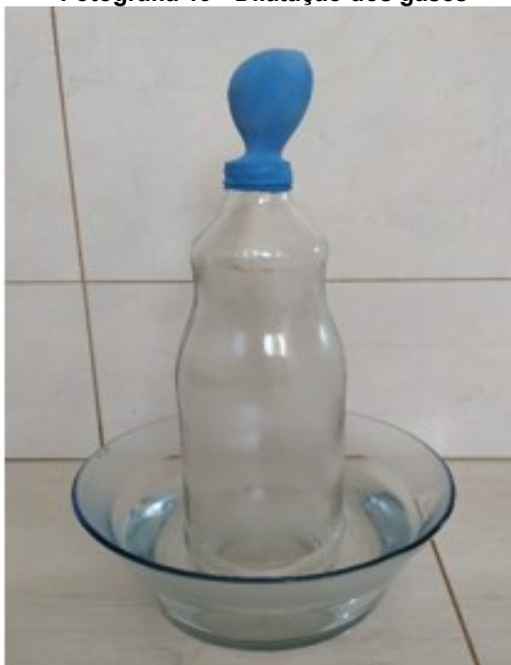
Fotografia 19 - Dilatação dos gases
