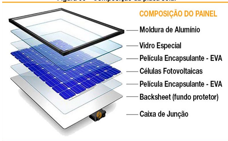
Figura 06 – Composição da placa solar
