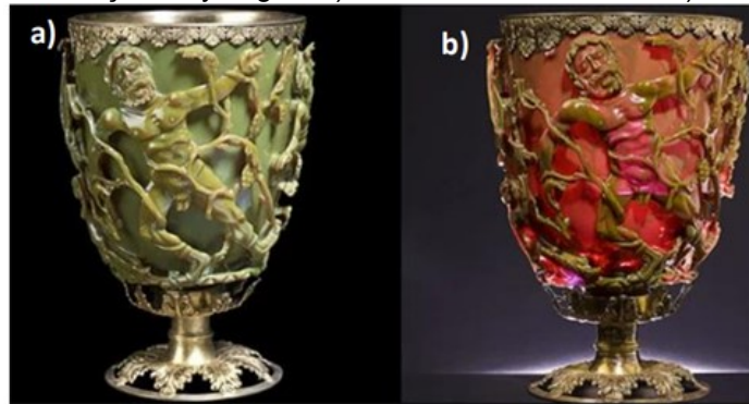
Figura 4: Imagens da Taça de Lycurgus, a) com a luz refletida e em b) com a luz transmitida
