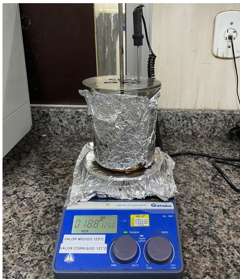
Figura 7 - Agitador e aquecedor com banho de glicerina para medir tempo de gel.
