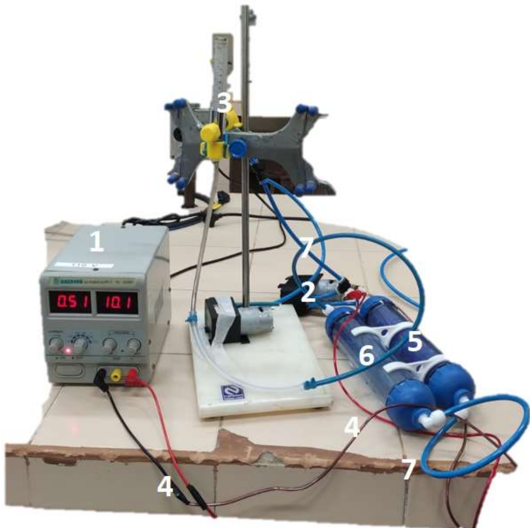
Figura 4 - Medição da vazão do compressor com o sistema montado para a liofilização à pressão atmosférica de alimentos
