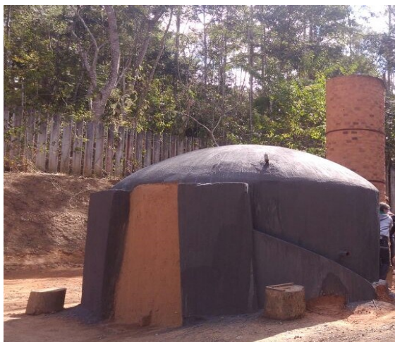
Figura 12 - Processo 2: Carbonização com combustão dos gases
