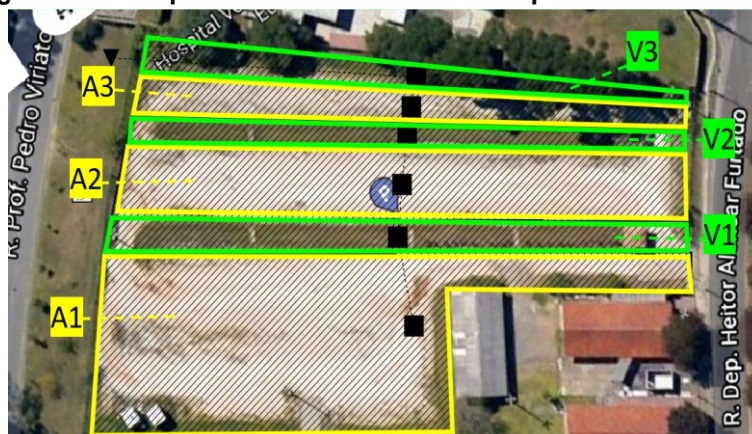
Figura 11 - Croqui da divisão de sub-bacias produzido no SWMM.
