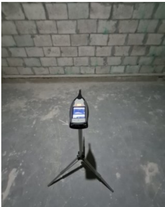
Figura 5 - Analisador de frequências na sala inferior posicionado para iniciar a medição
