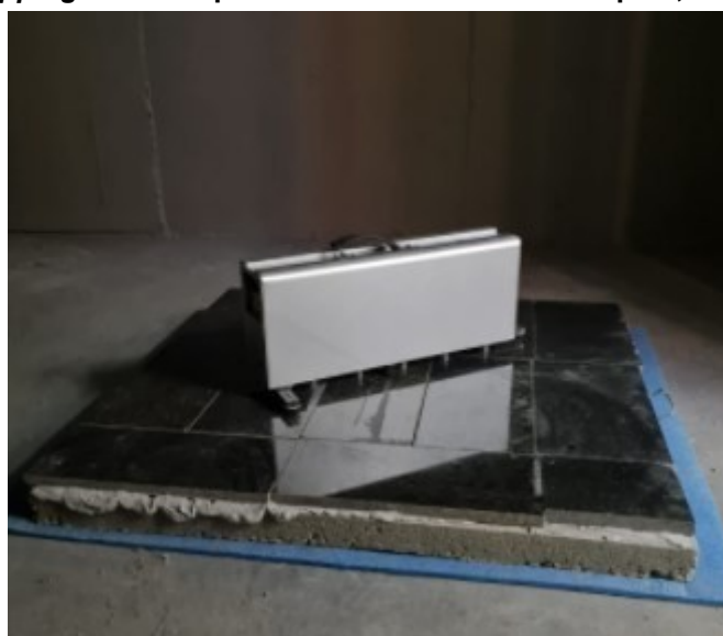
Figura 4 - Tapping machine posicionada acima do contrapiso, na sala superior
