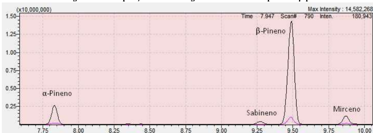
Figura 7 - Sobreposição do cromatograma referente ao \alpha -pineno e \beta -pineno
