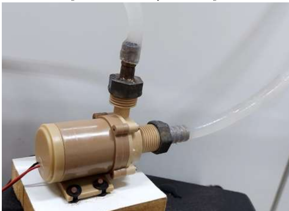
Figura 6 - Bomba utilizada para reciclo de água no sistema
