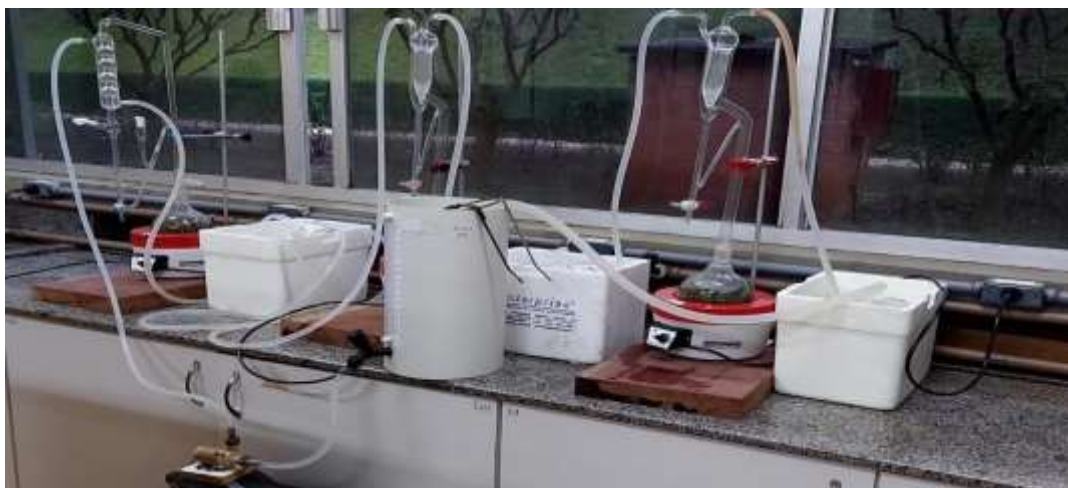
Figura 5 - Sistema de hidrodestilação em triplicata
