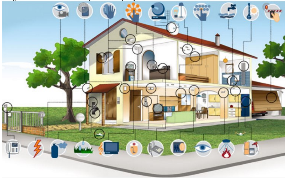
Figura 1 – Recursos e dispositivos que podem ser controlados utilizando a Domótica
