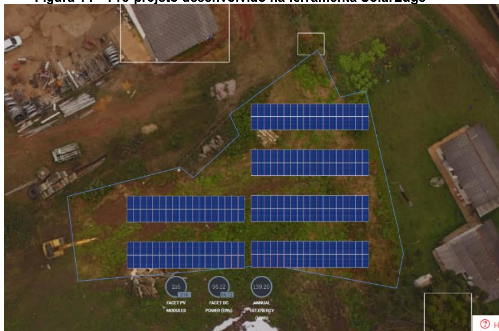
Figura 14 – Pré-projeto desenvolvido na ferramenta SolarEdge
