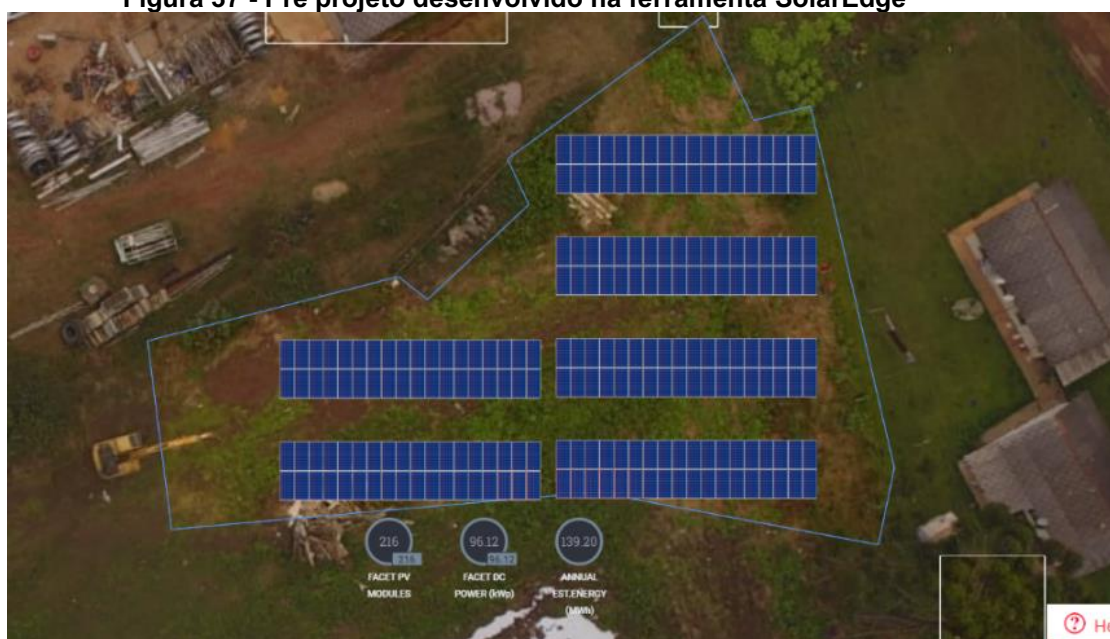
Figura 37 - Pré projeto desenvolvido na ferramenta SolarEdge
