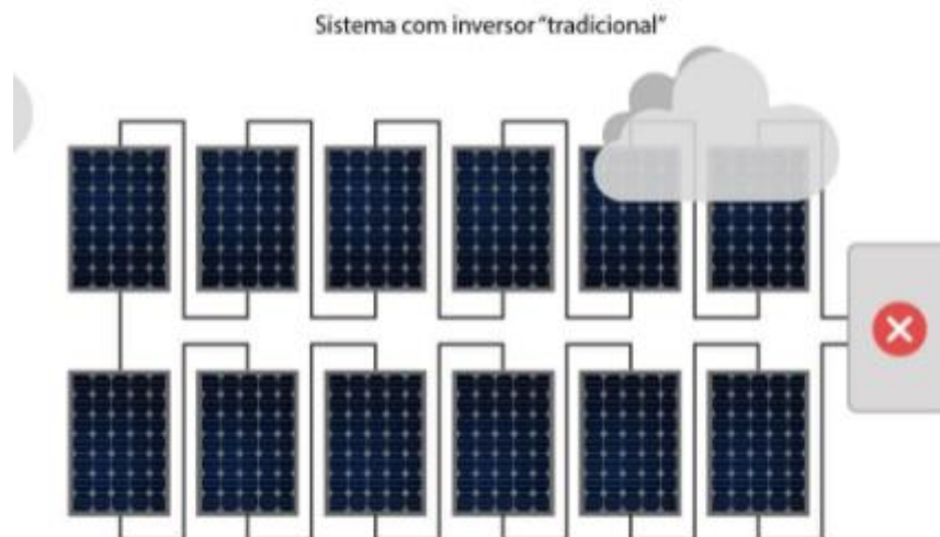
Figura 8 - Influência de sombreamento em inversor de string
