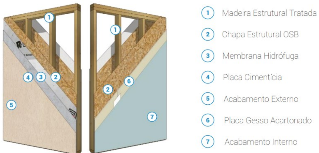
Figura 5 - Revestimento das Paredes
