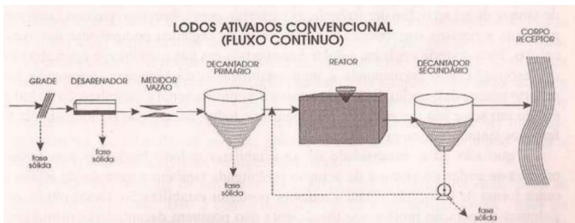
Figura 6 - Fluxograma de um sistema de lodos ativados convencional
