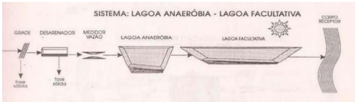
Figura 3 - Fluxograma de um sistema de lagoa anaeróbia - facultativa
