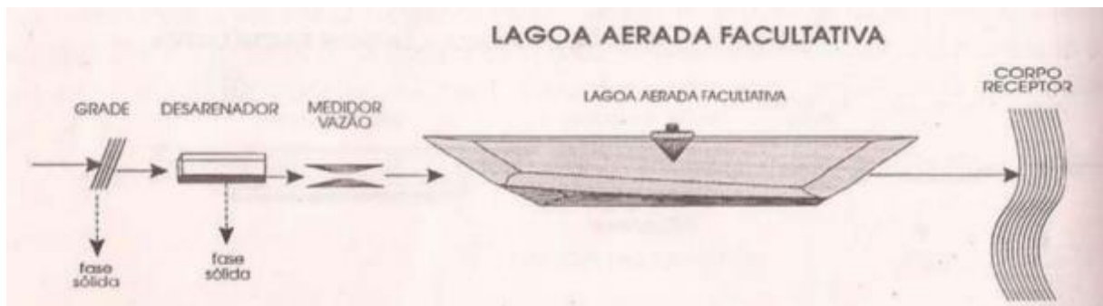
Figura 4 - Fluxograma de um sistema de lagoa aerada facultativa
