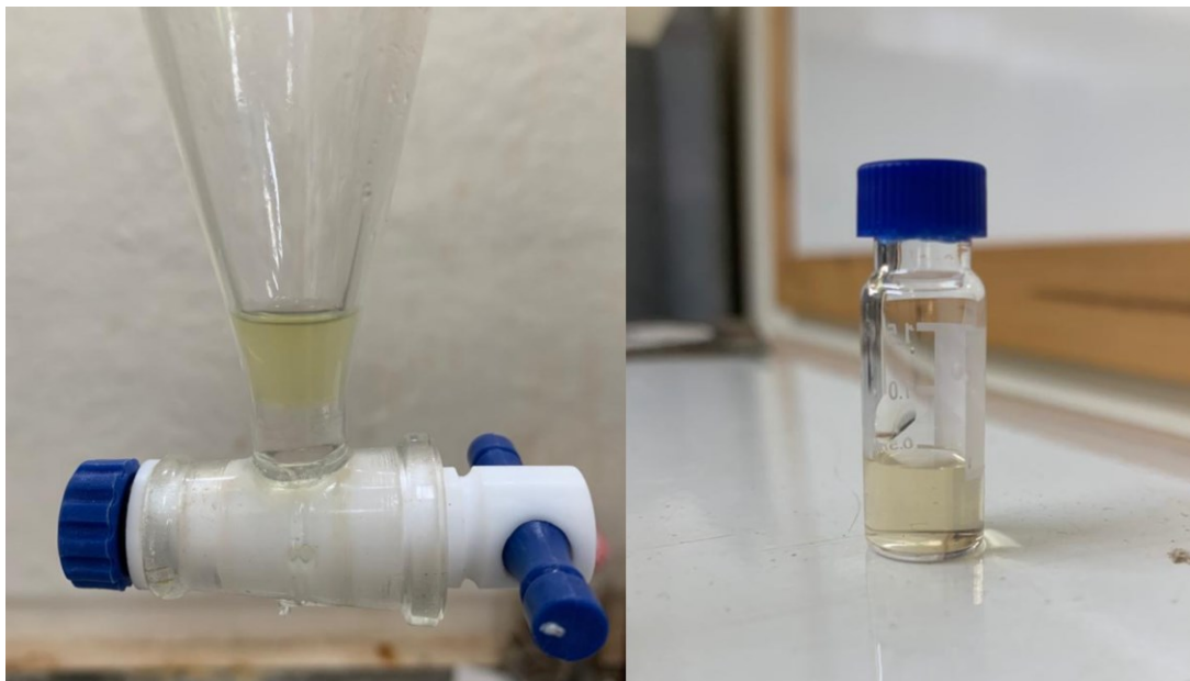
Figura 7- Óleo essencial obtido por arraste a vapor. Fonte: autoria própria.
