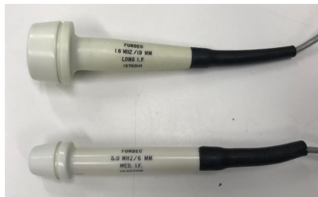
Figura 32 – Transdutores monoelemento de ultrassom com frequência central de 1,6 MHz e 5 MHz utilizados nos testes do sistema.
