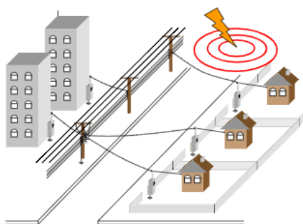
Figura 3 – Descarga atmosférica indireta.
