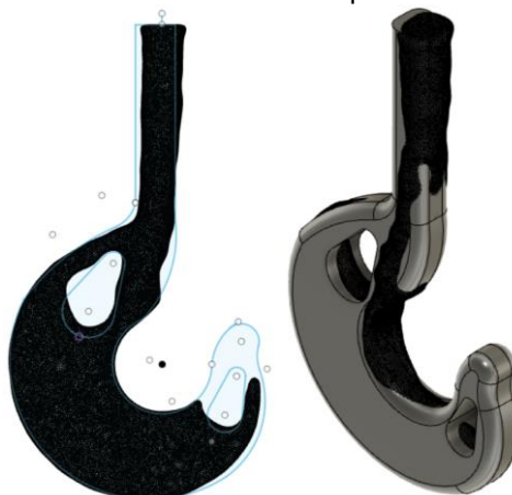
Figura 75 – (a) Perfil 2D do novo modelo projetado no elemento otimizado; (b) Novo modelo e elemento otimizado sobrepostos
