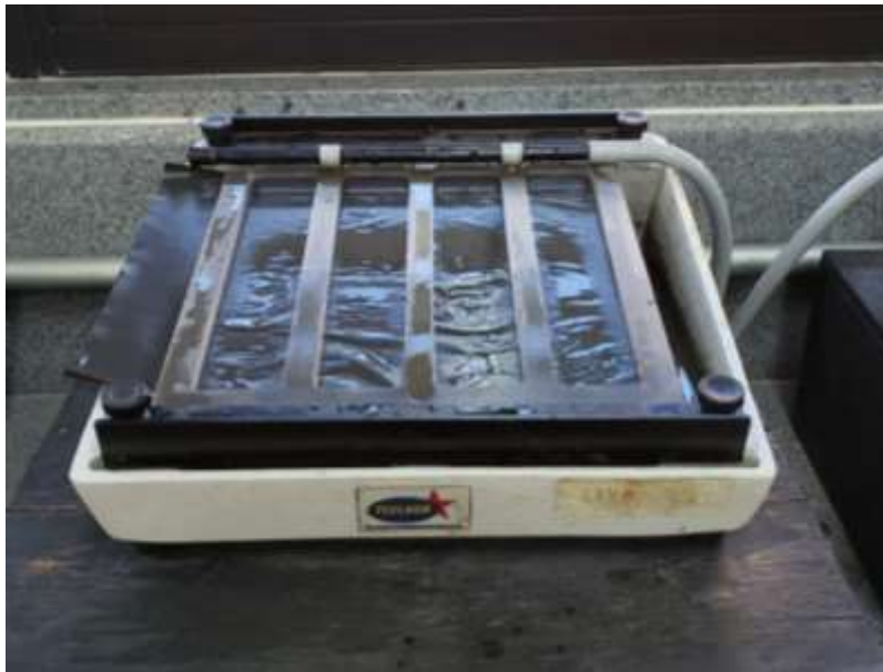
Fotografia 18 - Lixa d'agua no suporte com água corrente
