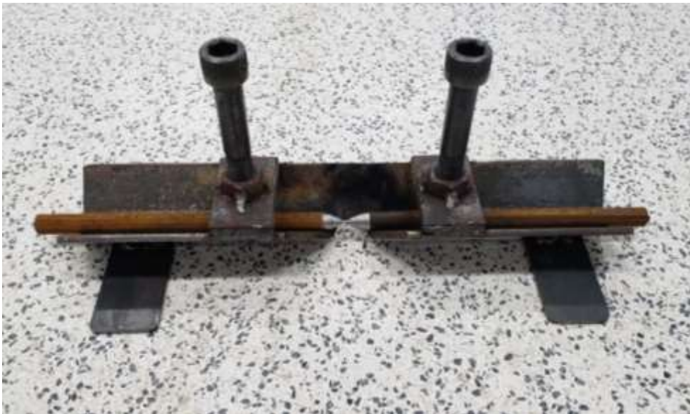
Fotografia 5 - Cantoneira com parafuso e corpos de prova fixadas
