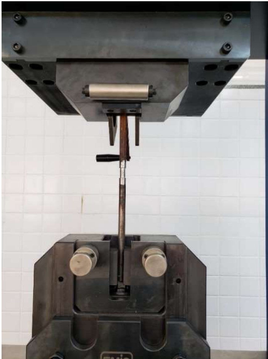
Fotografia 113 - Corpo de prova preso para o ensaio de tração
