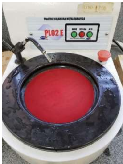
Fotografia 169 - Politriz Lixadeira Metalográfica PL02E
