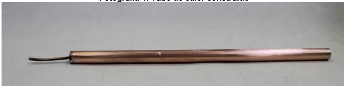
Fotografia 4: Tubo de calor construído
