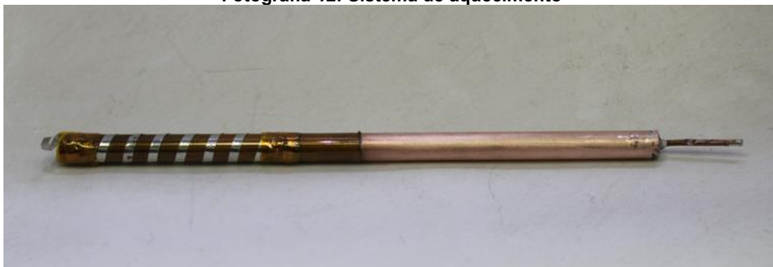
Fotografia 12: Sistema de aquecimento
