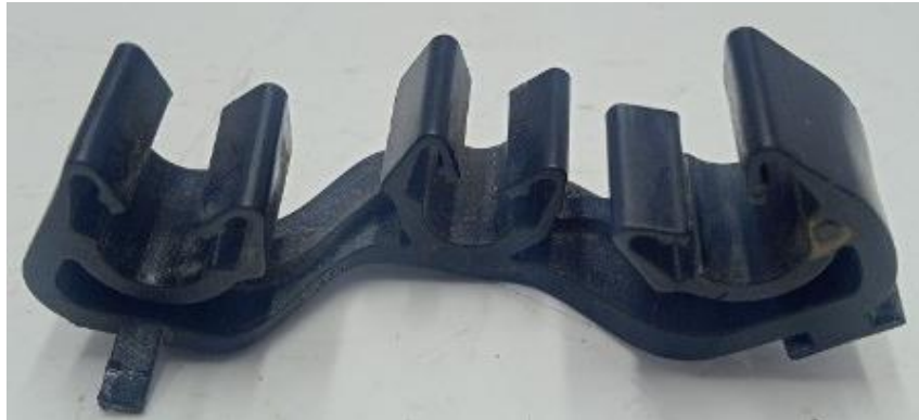
Figura 16 - Suporte Linha Combustível VW Polo
