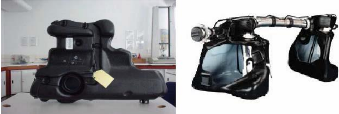
Figura 12 - Reservatório de combustível com formas complexas
