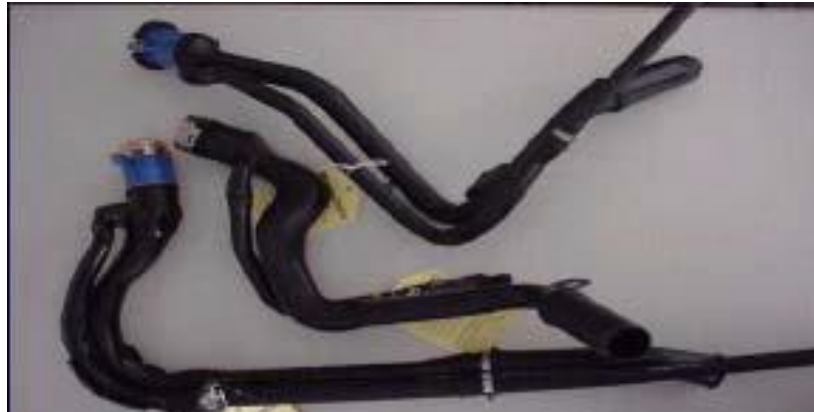
Figura 8 - Exemplo de gargalos do sistema de combustível
