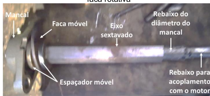
Figura 15 - Pré-montagem do eixo sextavado com o mancal de apoio, buchas espaçadoras e uma faca rotativa
