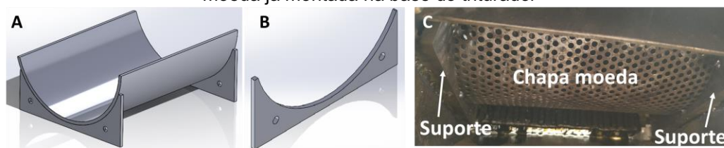
Figura 13 - (A) Pré-montagem do suporte da tela de saída, (B) suporte e (C) fotografia da chapa moeda já montada na base do triturador
