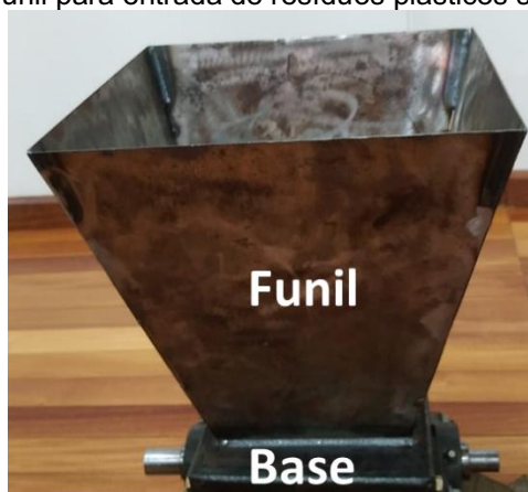
Figura 17 – Fotografia do funil para entrada de resíduos plásticos soldado na base do triturador
