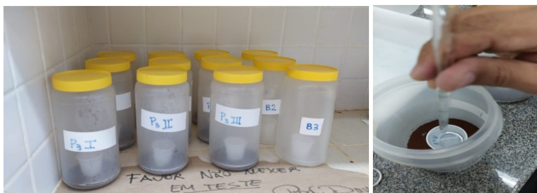
Figura 14 - Ensaio para determinação da respiração basal do solo (RBS)
