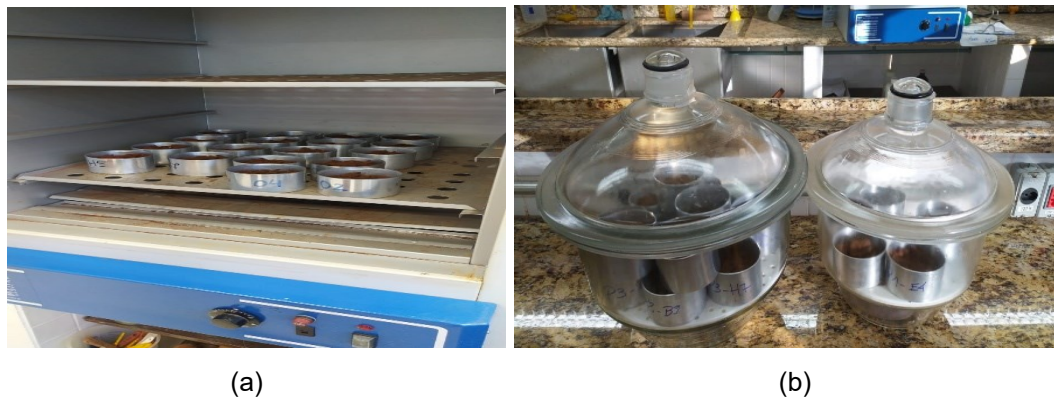
Figura 12 – (a) Amostras de solos para o ensaio de densidade; (b) amostras de solo para o ensaio de umidade natural e higroscópica realizados no laboratório de solos da UTFPR-FB
