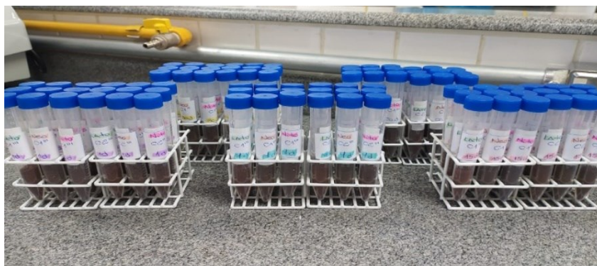
Figura 16 - Amostras de solos armazenadas e organizadas simetricamente, após dopagem com solução de AT
