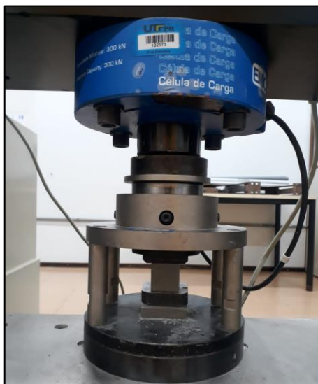
Figura 26 – Ensaio de resistência à compressão
