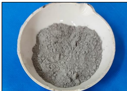
Figura 17 – Escória de alto forno após moagem
