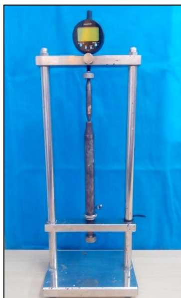
Figura 25 – Comparador de comprimento
