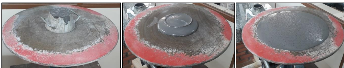
Figura 27 – Ensaio de índice de consistência
