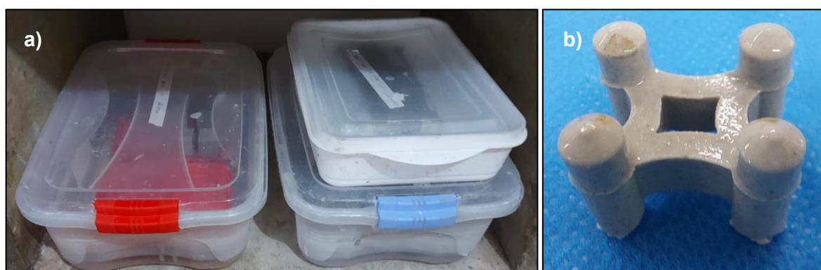
Figura 23 – a) Recipientes para cura úmida; b) espaçador de plástico tipo cadeirinha
