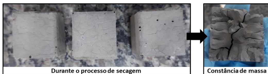
Figura 30 – Condições físicas das amostras de CAT após ensaio de absorção de água
