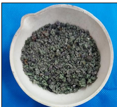
Figura 16 – Escória de alto forno granulada Fonte: Autoria própria.
