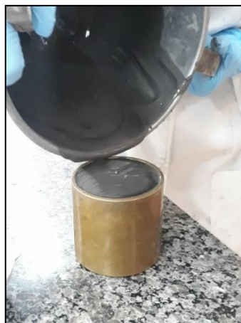
Figura 28 – Ensaio de massa específica
