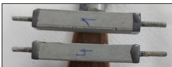
Figura 24 – Aplicação de resina epóxi
