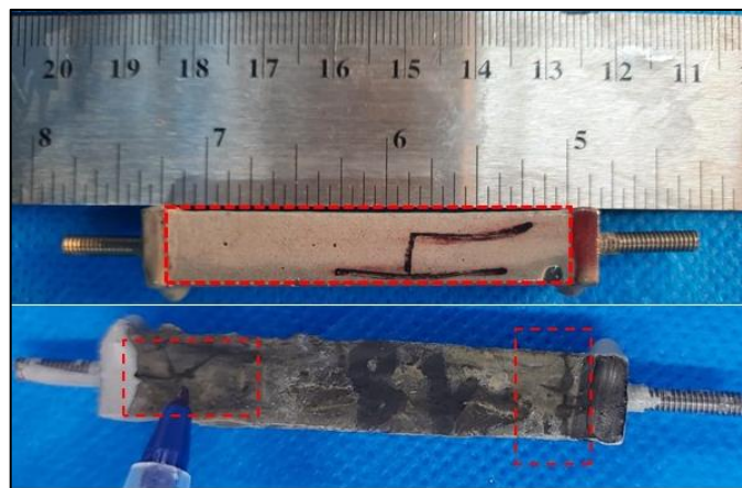
Figura 37 – Empenamento e fissuração das amostras
