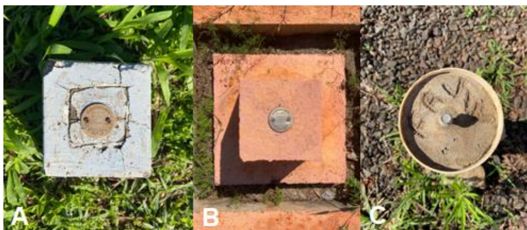
Figura 13 – (A) Antigo marco geodésico (UTFPR01), (B) Novo marco geodésico (UTFPR02) e (C) marco UPA. Fonte: A autora (2021).
