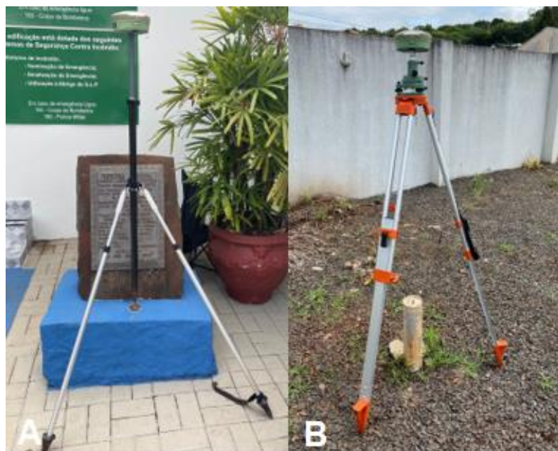
Figura 15 – Posicionamento Relativo Estático, (A) Base de referência estação 96153 (B) Rover Marco UPA. Fonte: A autora (2021).
