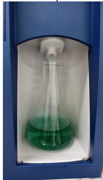
Figura 10 - Destilação das amostras
