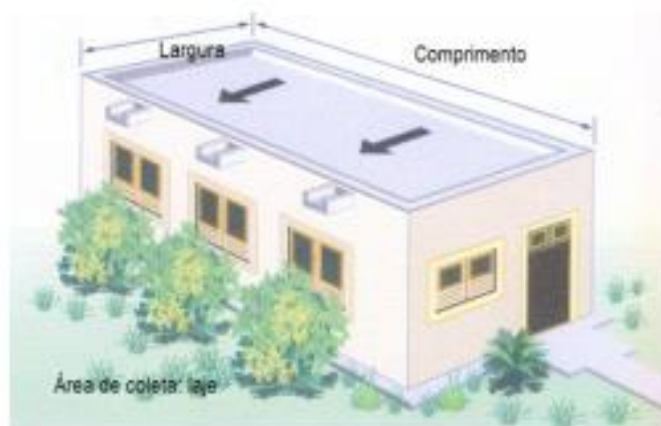
Figura 11: Área de coleta - laje: comprimento x largura
