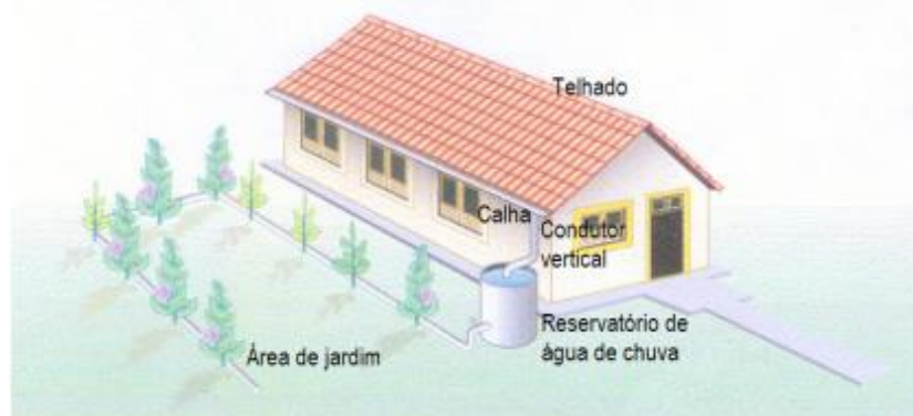
Figura 14: Irrigação de jardins: área de coleta, condutor horizontal (calha), condutor vertical, sistema de armazenamento (reservatório) e sistema de distribuição para rega do jardim
