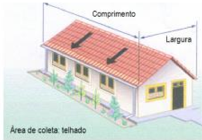
Figura 10: Área de coleta - telhado: comprimento x largura
