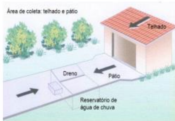
Figura 12: Área de coleta - telhado e pátio: armazenamento em reservatório subterrâneo
