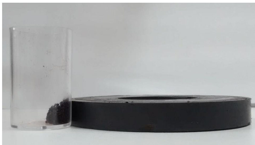
Figura 28 - Caráter magnético das nanopartículas, designadas como NP 1, após secagem.
