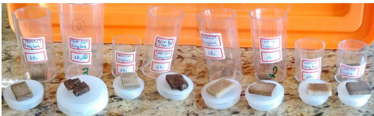
Figura 34 - Amostras de membranas com a deposição realizada. A ordem, da esquerda para a direita: sem funcionalização, a 1 mg/mL, 1 hora; sem funcionalização, 5 mg/mL, 1 h; sem funcionalização, 1 mg/mL, 2 h; sem funcionalização, 5 mg/mL, 2h; com funcionalização, 1 mg/mL, 1h; com funcionalização, 5 mg/mL, 1h; com funcionalização, 1 mg/mL, 2h; com funcionalização, 5 mg/mL, 2h.
