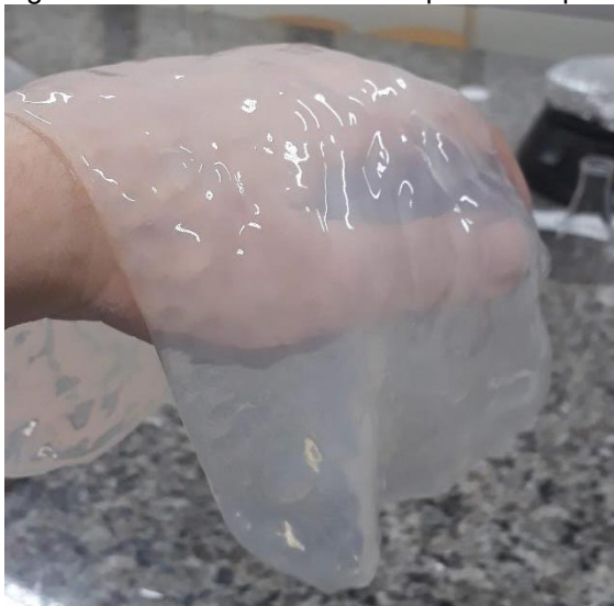
Figura 11 – Celulose bacteriana produzida por fermentação.
