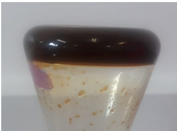
Figura 7 - Gel das Microcápsulas de sílica mesoporosa com Sulfametoxazol e Fe 2 O 3 (MPM-SMZ)
