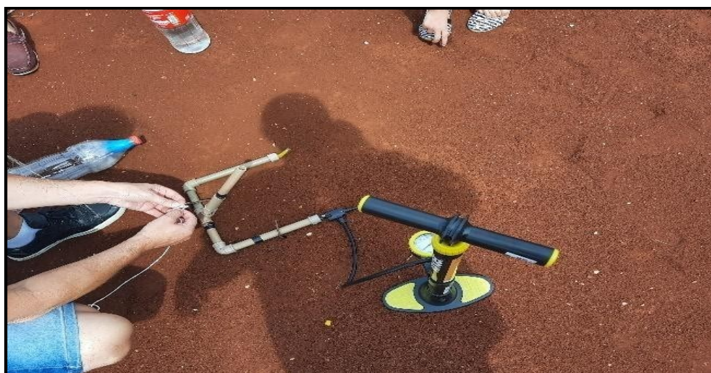
Figura 3 - Estrutura que auxilia no impulsionamento do foguete
