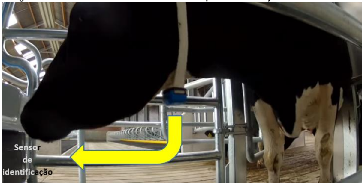
Fotografia 9 - Colar eletrônico no momento da leitura para a identificação do animal
