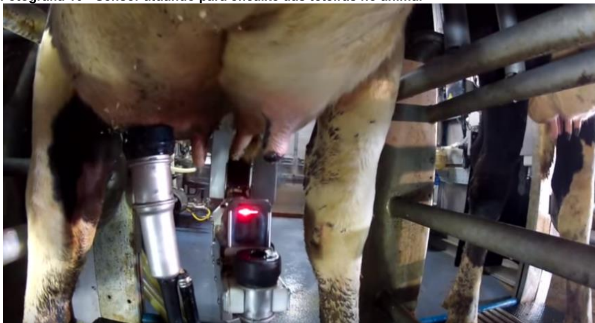
Fotografia 10 - Sensor atuando para encaixe das teteiras no animal
