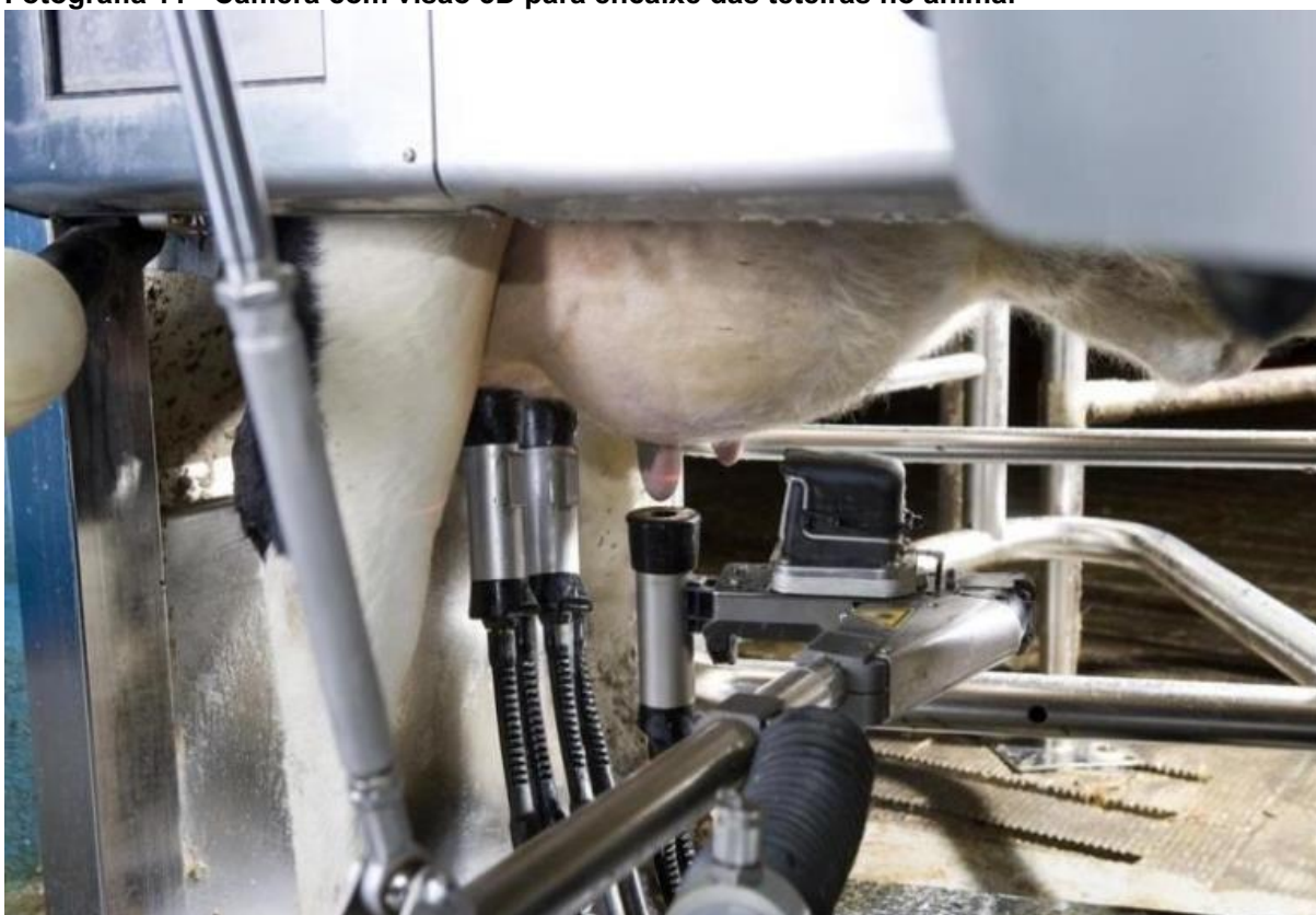
Fotografia 11 - Câmera com visão 3D para encaixe das teteiras no animal
