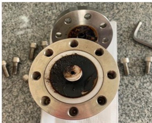
Figura 16 - Reator autoclave danificado
