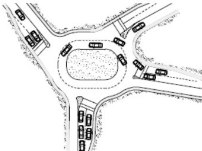
Figura 15 – Configuração de uma rótula com alongamento da ilha central
