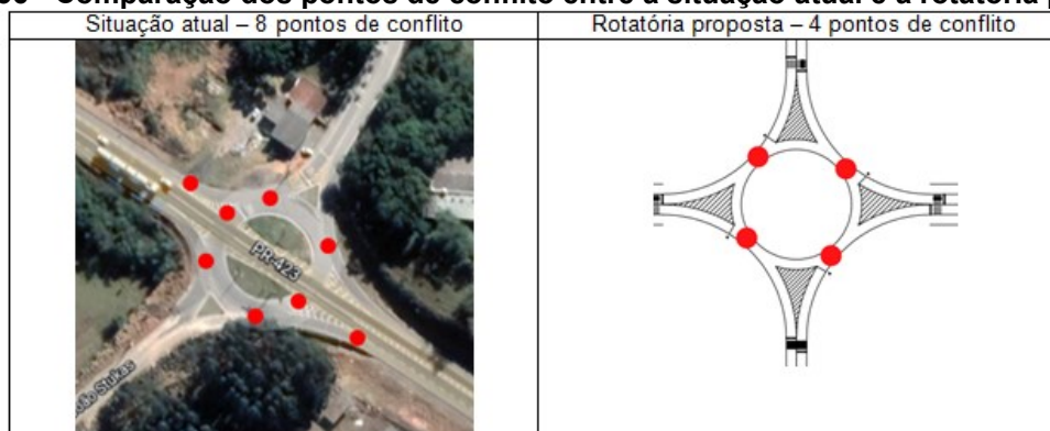
Figura 36 - Comparação dos pontos de conflito entre a situação atual e a rotatória proposta
