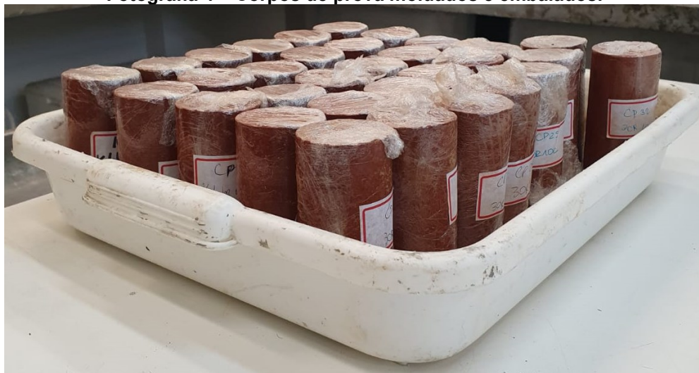
Fotografia 4 – Corpos de prova moldados e embalados.
