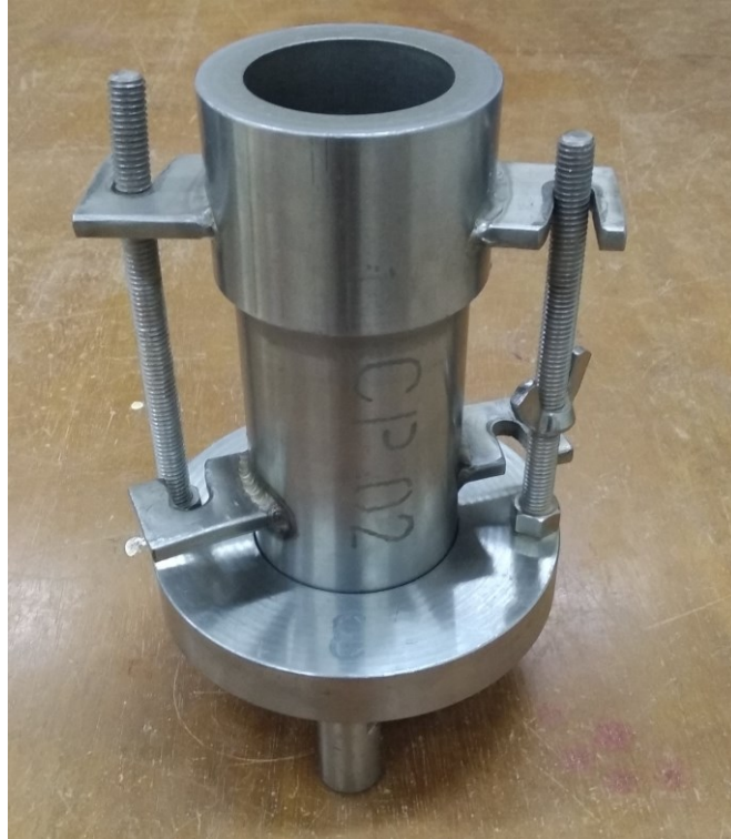
Fotografia 2 – Molde cilíndrico desenvolvido para a confecção dos corpos de prova
