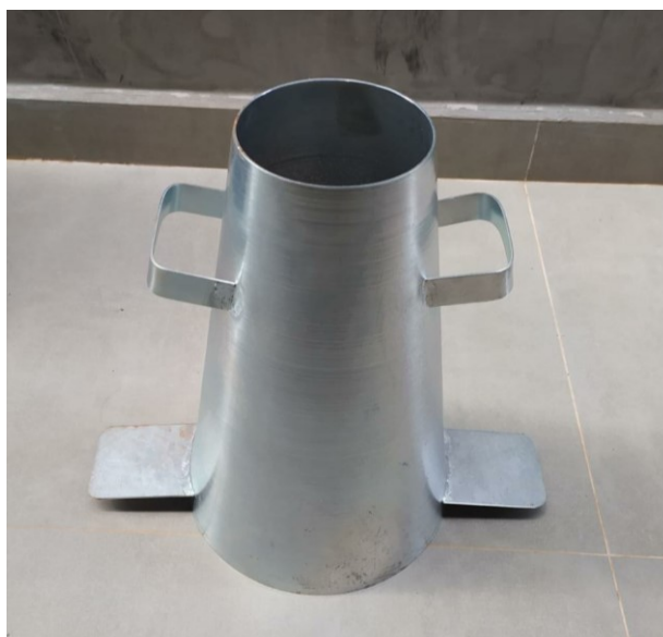
Figura 8 - Tronco cônico para realização do slump test
