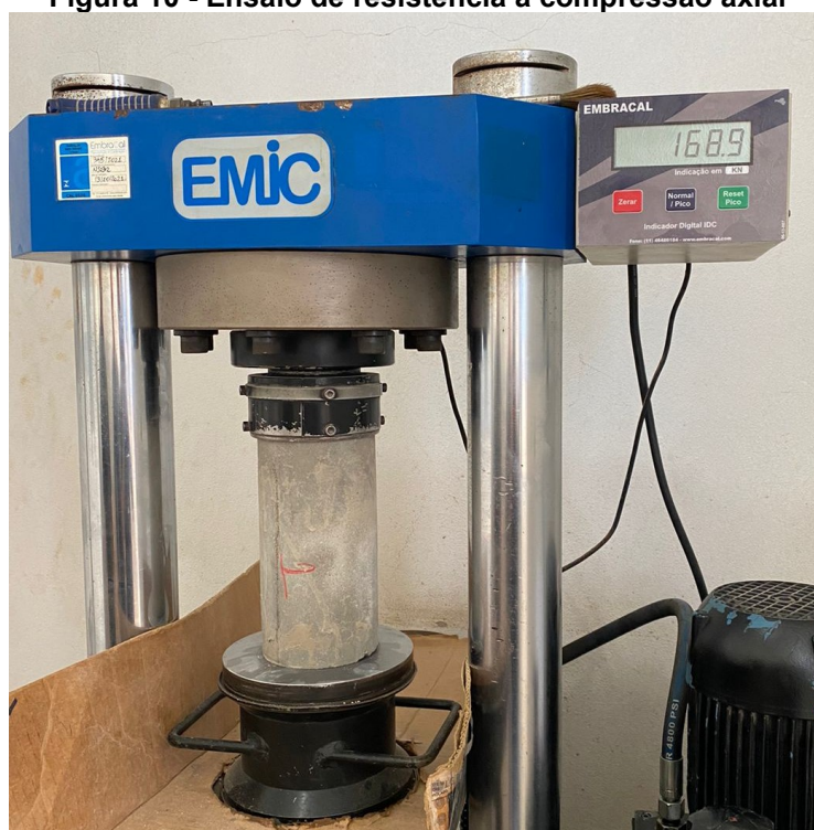
Figura 10 - Ensaio de resistência à compressão axial
