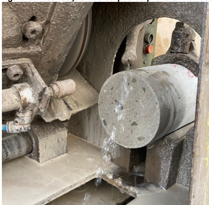
Figura 9 - Retificação dos corpos de prova cilíndricos
