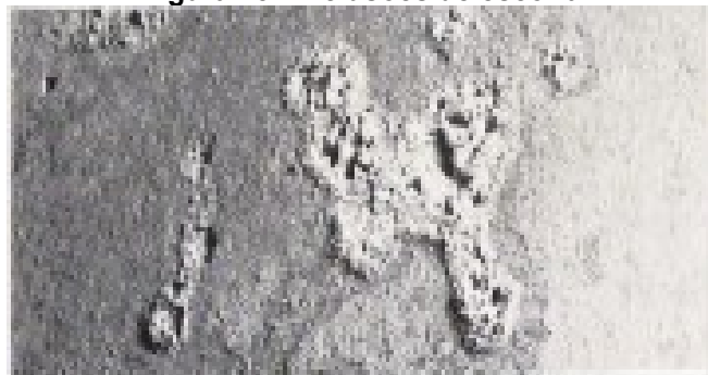
Figura 15 - Inclusões de escória
