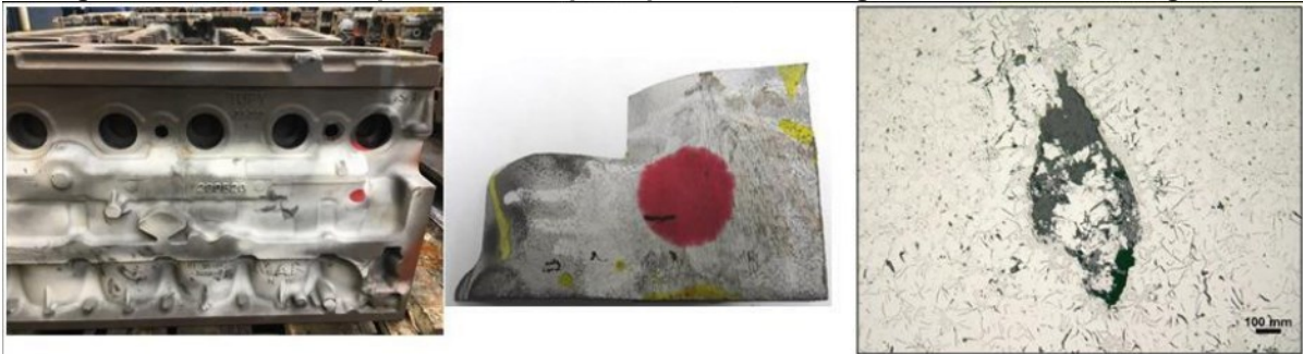
Figura 25 - Bloco com aplicação de líquido penetrante e região de análise metalográfica
