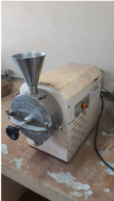
Figura 5: Moinho de facas utilizado para trituração do material utilizado como extrato. Fonte: Autor, 2018.
