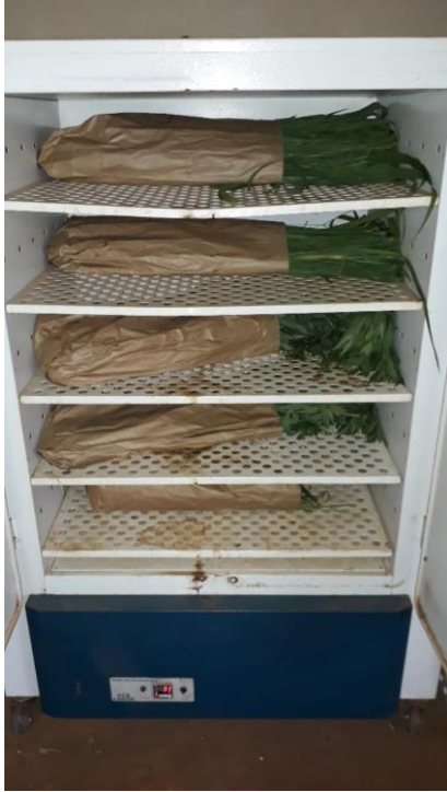
Figura 4: Plantas de cobertura prontas para secagem em estufa a 31°C. Fonte: Autor, 2018.
