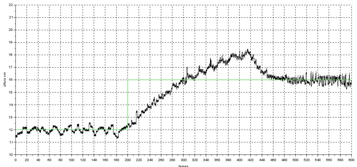
Gráfico 11 - Ensaio 3 do controle PID Arduino-Xcos com desvio no setpoint
